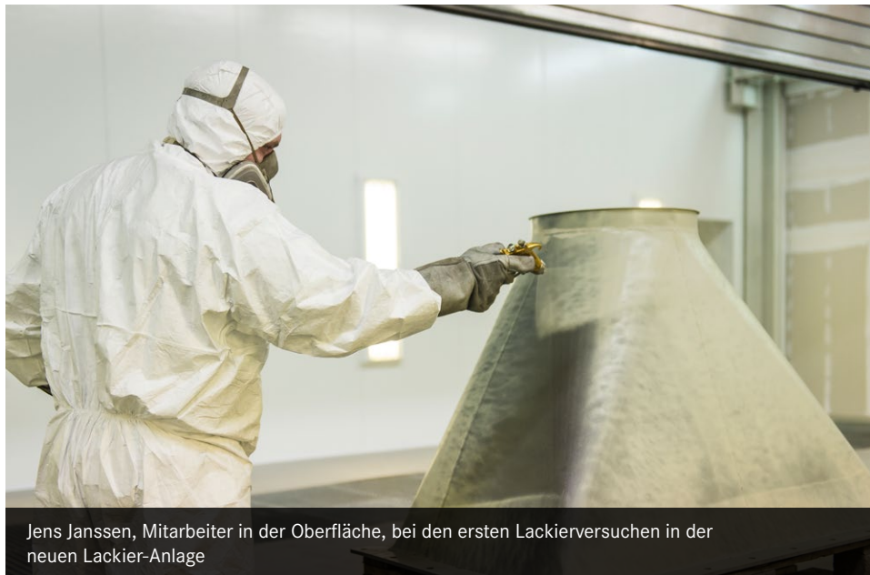
Blick auf die neue 2-teilige Lackierzelle mit forcierter Trocknung und auf die neue Beizanlage
