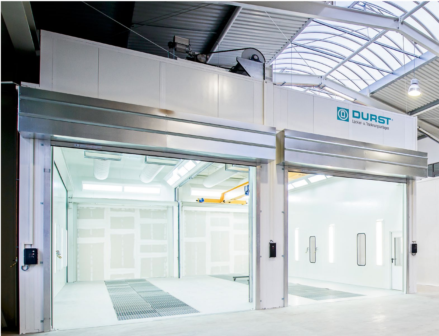
Blick auf die neue 2-teilige Lackierzelle mit forcierter Trocknung und auf die neue Beizanlage
