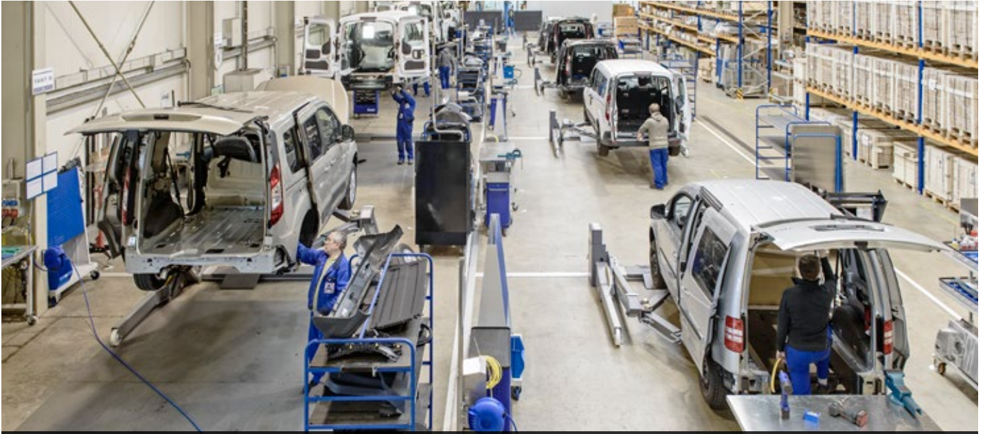
In der ehemaligen Endmontagehalle Förderanlagen entstehen Umbauten für Dacia Dokker und Ford Connect nach modernsten Anforderungen
